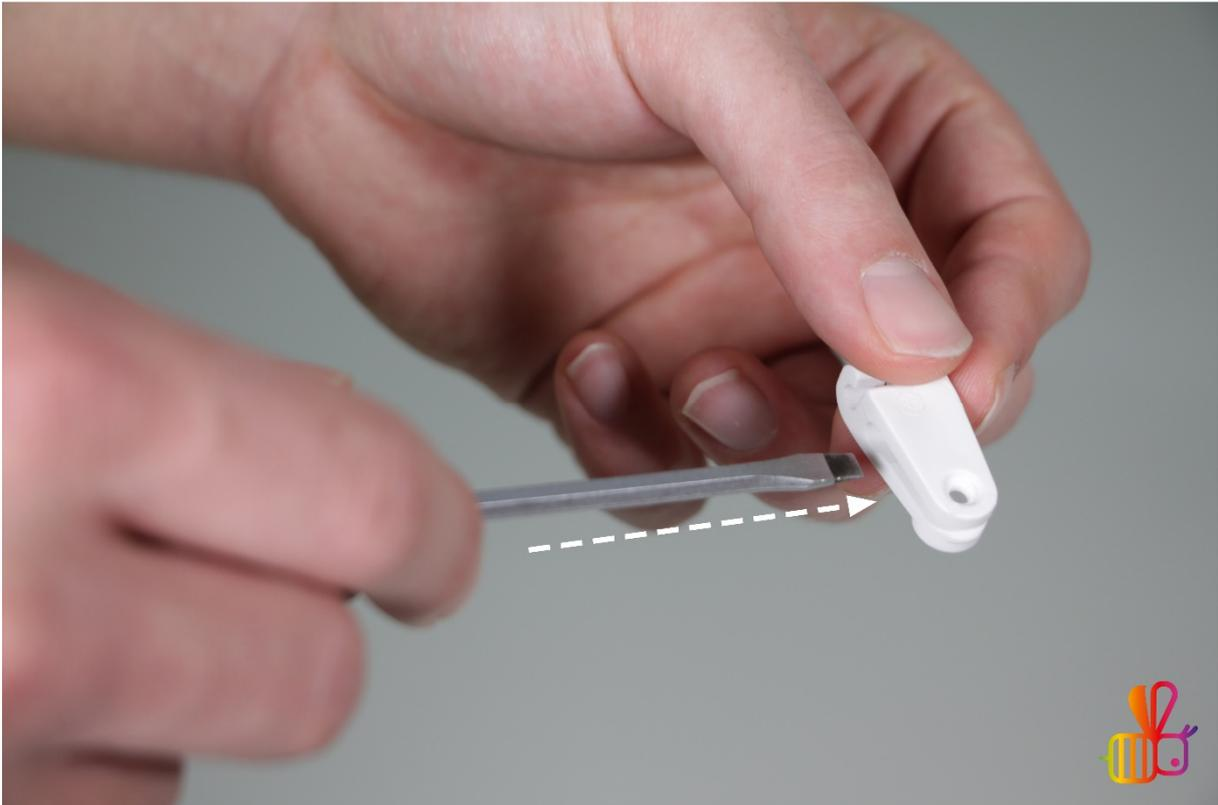
Mit dem Schlitzschraubenzieher können Sie den Laufhaken weiter öffnen, dadurch erleichtert sich das aufschieben der Laufhaken auf den Stoffsaum.
