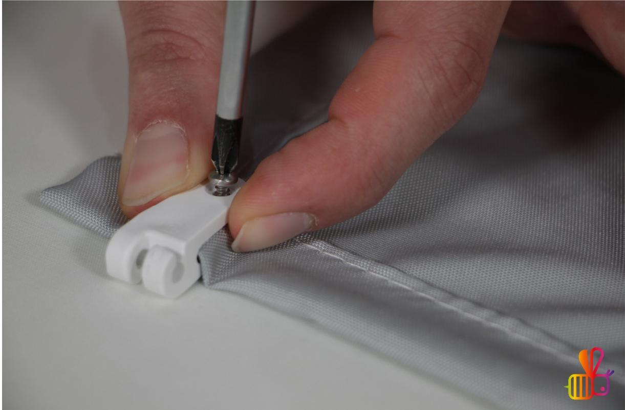
Schrauben Sie nun den ersten Laufhaken mit der beigelegten Schraube fest. Halten Sie den Laufhaken mit einer Hand um ein verdrehen zu verhindern.
